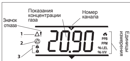
1. Значок аварийной сигнализации 2. Значок блокировки канала 3. Значки уровней аварийной сигнализации
