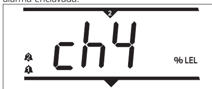
Figura 3.3 Ejemplo de sistema en estado de alarma
