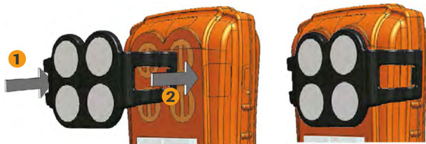
Afbeelding 6: De externe filterplaat plaatsen
