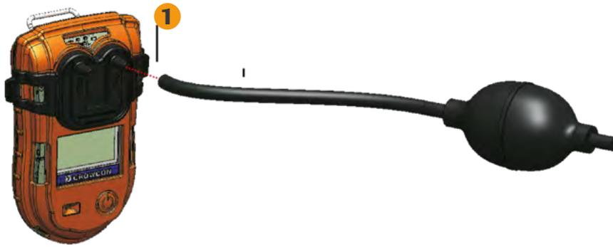
**Figure 10: Raccordement de l'aspirateur manuel**
