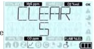
Le mode crête peut également être utile pendant les vérifications avant entrée dans un espace confiné. Le mode crête peut être sélectionné et le **T4x** introduit dans la zone à contrôler. Quand le **T4x** est ensuite retiré de l'espace, les relevés de crête de gaz seront affichés à l'écran. Une alarme peut être annulée et les valeurs de crête de gaz continueront à être affichées à l'écran.
