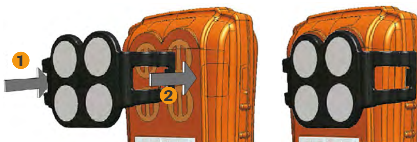
Figura 6: Montagem da placa de filtro externa
