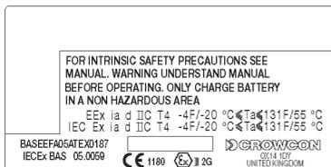
2. Das Gerät darf in den Zonen 1 und 2 mit brennbaren Gasen der Gruppen IIA, IIB und IIC, Temperaturklassen und Dämpfen T1, T2, T3 und T4 eingesetzt werden.
