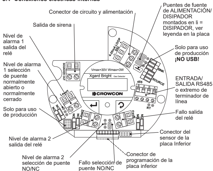
Diagrama 6: Xgard Bright conexiones eléctricas internas
