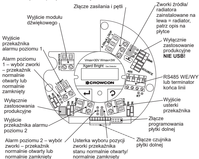
Schemat 6: Xgard Bright wewnętrzne połączenia elektryczne
