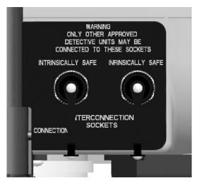
Lorsqu'un appareil dans un tel système détecte une alarme de gaz, il déclenche l'alarme sur tous les appareils. L'appareil qui détecte l'alarme va signaler l'alarme de la manière habituelle décrite dans les chapitres précédents. Les autres appareils du système vont signaler une alarme par un clignotement bien plus lent des feux instal-lés sur le dessus. Ceci permet aux utilisateurs de déterminer à quel endroit l'alarme de gaz est survenue.
