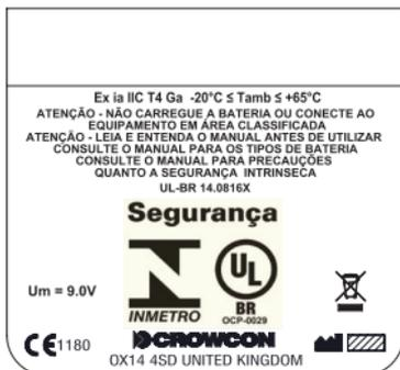
1. O equipamento deverá ser usado nas zonas 1 e 2 nas M07637 Braz\_Port.indd 4 18/5/05 17:04:08 versões inflamáveis e zonas 0, 1 e 2 para as versões tóxicas, para o grupo IIA, IIB e IIC classes de temperatura T1, T2, T3 e T4.
